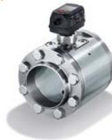
Durch zusätzlich integrierte Sensoren für Druck und Temperatur stehen gleich vier Prozesswerte (Durchfluss, Druck, Temperatur und Gesamtverbrauchsmenge) zur Verfügung und geben Aufschluss über die Energieeffizienz einer Anlage. Natürlich lassen sich alle Prozesswerte schnell und einfach per IO-Link übertragen.
