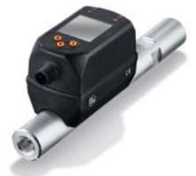
Mit konstant hoher Präzision erfasst der Luftspaltsensor den Abstand zwischen Auflagefläche und Objekt und gibt diesen als absoluten Wert aus. Der Sensor lässt sich über Tastenbedienung, externen Eingang oder aber mit nur einem Klick per IO-Link auf den Sollzustand anlernen. Damit kann bei einem Produktionswechsel die Rüstzeit der Anlage stark reduziert werden.
