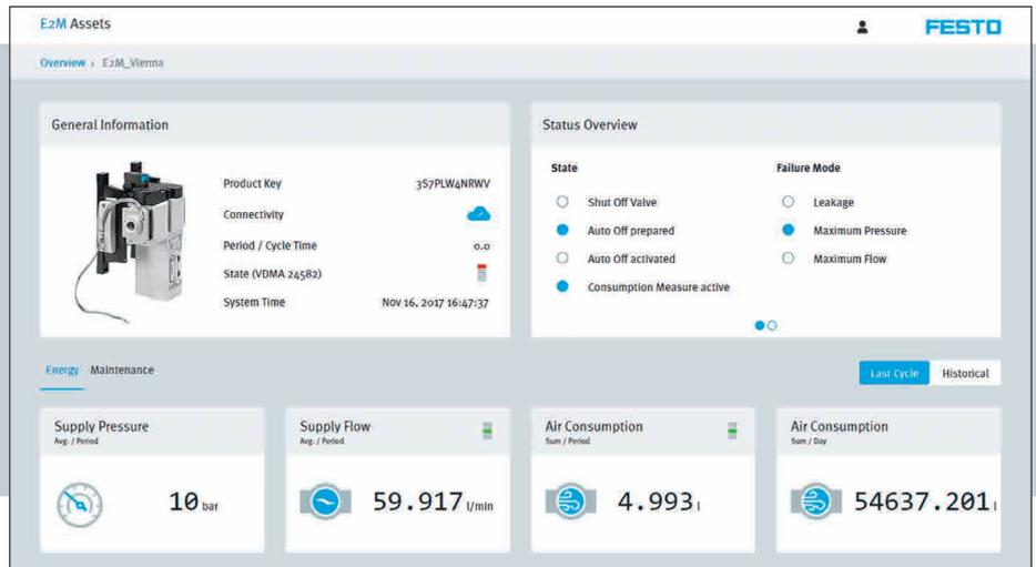
In einem Pilotprojekt war Festo der erste Partner, der mit dem Energie-Effizienz-Modul MSE6-E2M ein intelligentes Feldgerät über ein eigenes IoT-Gateway CPX-IOT in die MindSphere integriert hatte. Das Pilotprojekt konnte folgende vier Kernaspekte zeigen:
