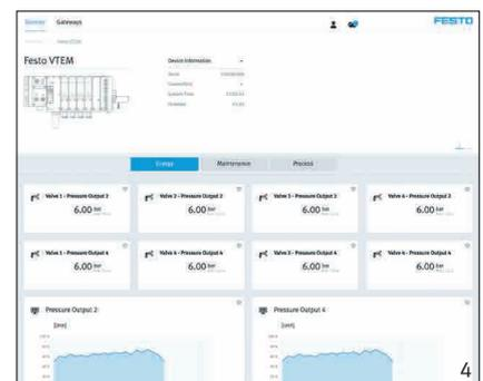
\* Diese Produkte von Festo sind damit Cyber-physikalische Systeme im Sinne von Industrie 4.0. Sie nehmen Daten aus der Applikation und dem Gerät selbst auf, leisten eine Vorverdichtung, indem sie diese Daten in Diagnosebausteinen nach VDMA 24582 in CODESYS V3 aufbereiten, und leiten diese Informationen anschließend an die Cloud weiter – Festo Dashboards als Beispiele anbei.
