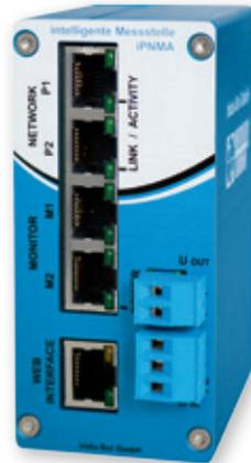
Die Auswertung der aufgezeichneten Daten erfolgt in diesem Fall nicht auf dem Gerät selbst, vielmehr werden alle Daten mit der Software **PROmanage® NT** (siehe Seite 24) abgefragt und für die Auswertung entsprechend aufbereitet.
