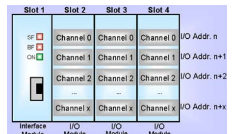
Rys 6: Model urządzenia dla PROFINet IO odpowiada modelowi PROFIBUS DP
